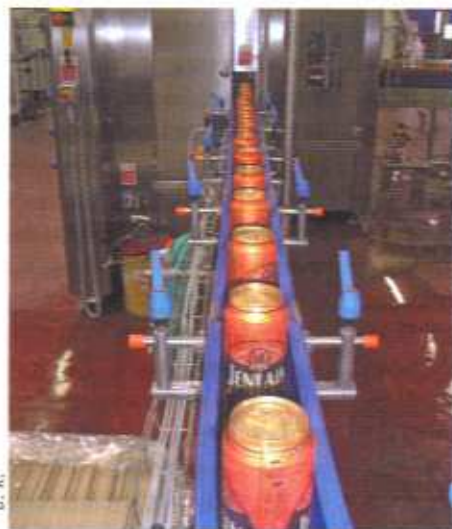
À la sortie de la soutireuse.
